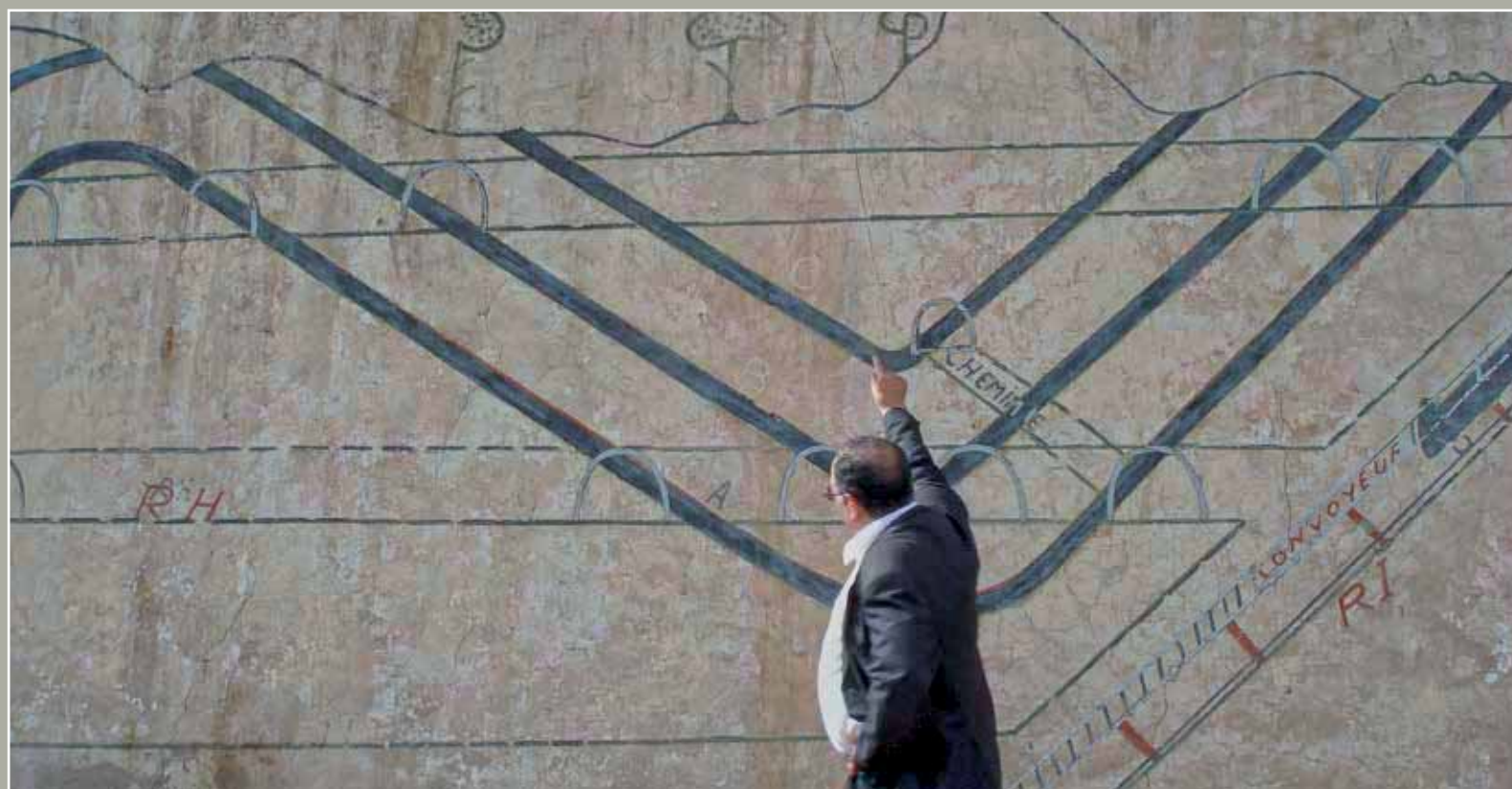
► Sur les parois de la «Mine Image», sont tracés les filons d'anthracite ainsi que la trame des galeries qui desservent les chantiers d'abattage (Photos Hicham Oudghiri)
