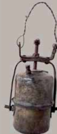
➤ Lampe à acétylène des années 1930. (l'eau réagit sur le carbure de calcium et produit un gaz combustible qui donne de la lumière en brûlant)
