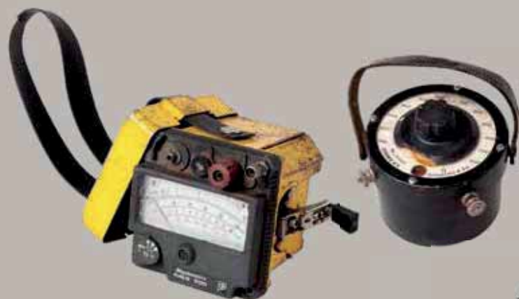
➤ Explodeur de mines, à la fois générateur et dynamo, il fait exploser la dynamite (1970)
