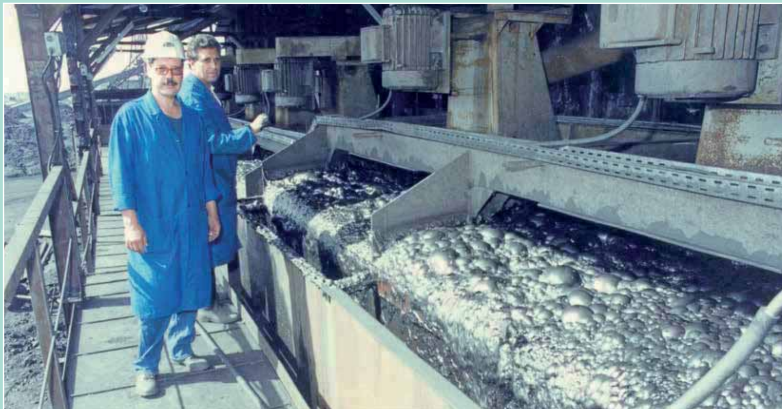
► Le lavoir de Hassi Blal et ses bacs vibrants montés sur des vérins pneumatiques (1993) (archives)
