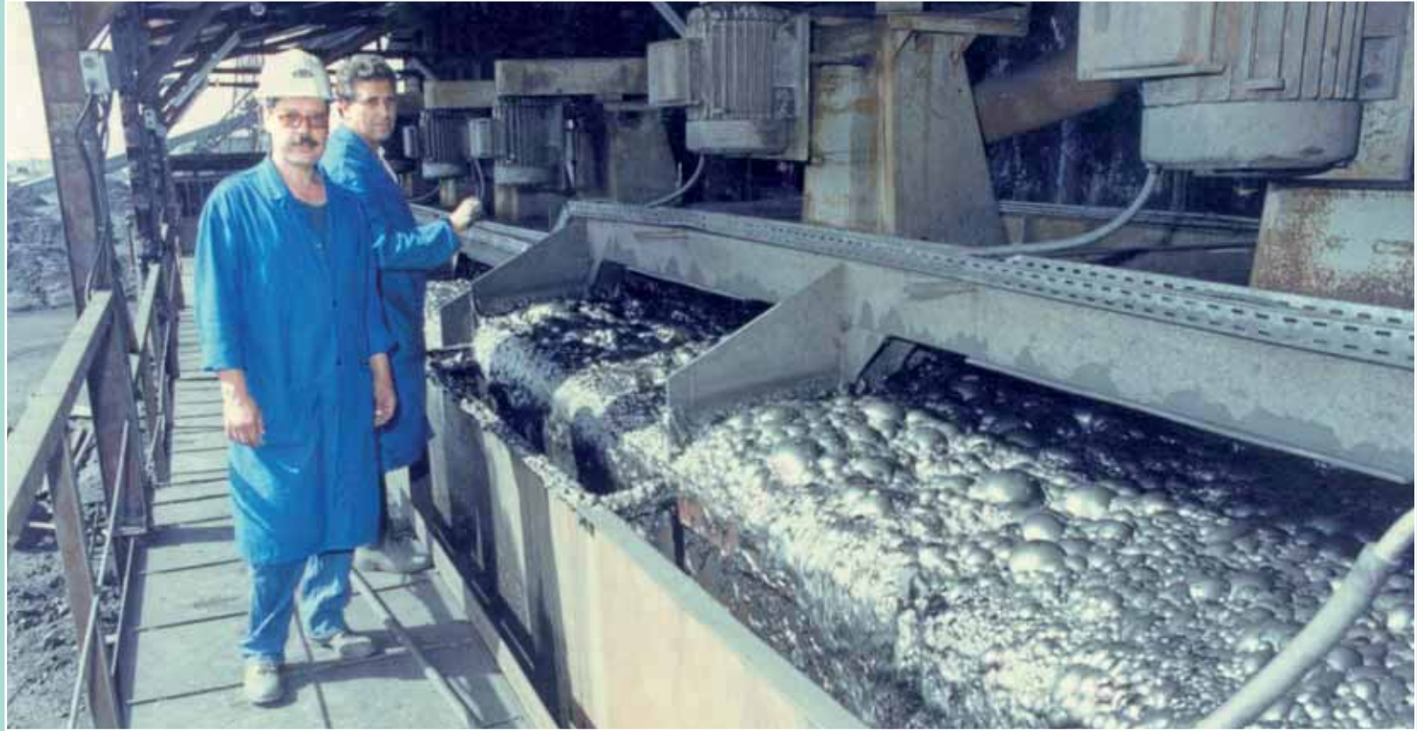
◀ مغسل حاسي بلال وأحواضه المتدببة المحمولة على أسطوانات تعمل بالضغط الهوائي (أرشيف) (1993)
