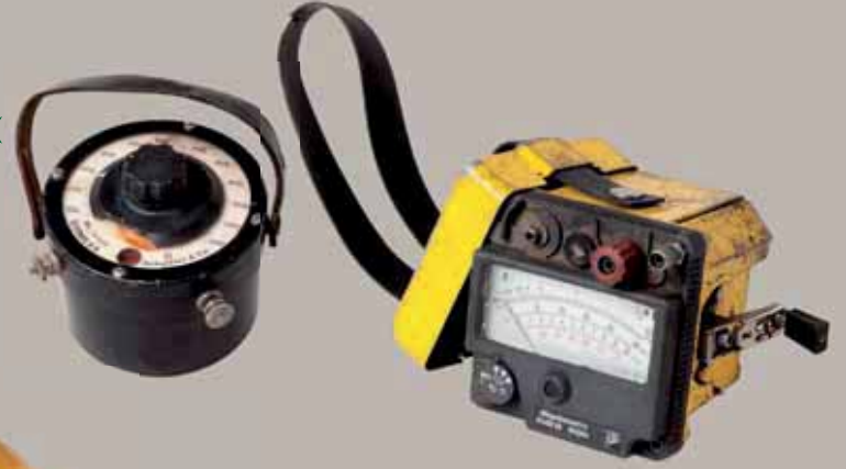
مفجر المناجم، وهو في نفس الوقت مولد كهرباء متصل ومولد كهرباء متقطع، ويمكن من تفجير الديناميت (1970)
