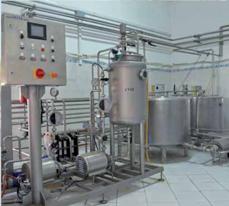
معدات لإستخراج الزيوت الأساسية للنباتات العطرية والطبية بكفايت (صورة هشام الودغيري)
