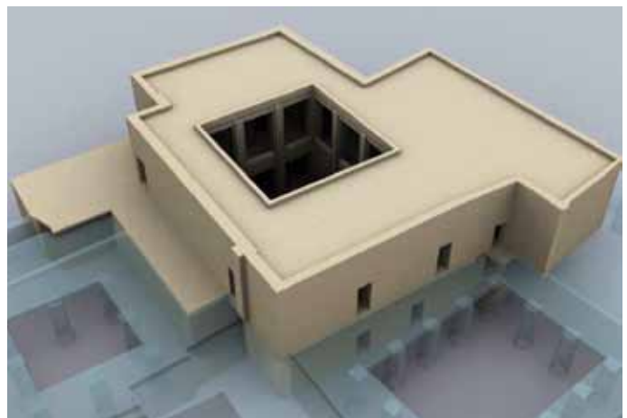
PHASE 10- Couverture horizontale du plancher au deuxième étage par chape en terre, sable et chaux
