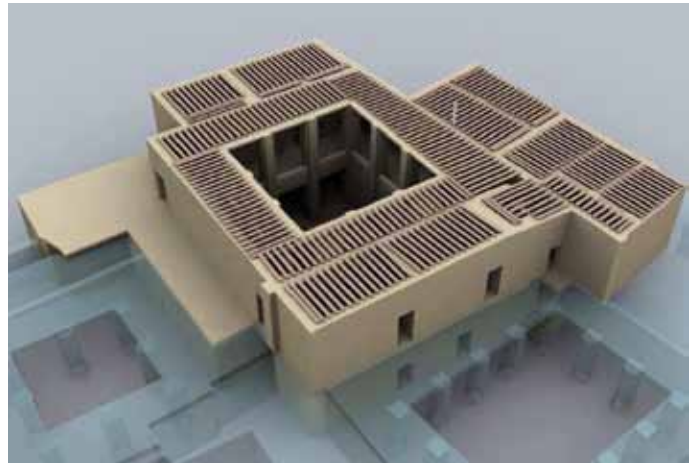
PHASE 8- Structure du plancher au dernière étage en poutres de bois de palmier
