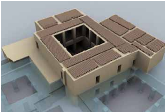
PHASE 9- Couverture horizontale du plancher au deuxième étage en karnef
